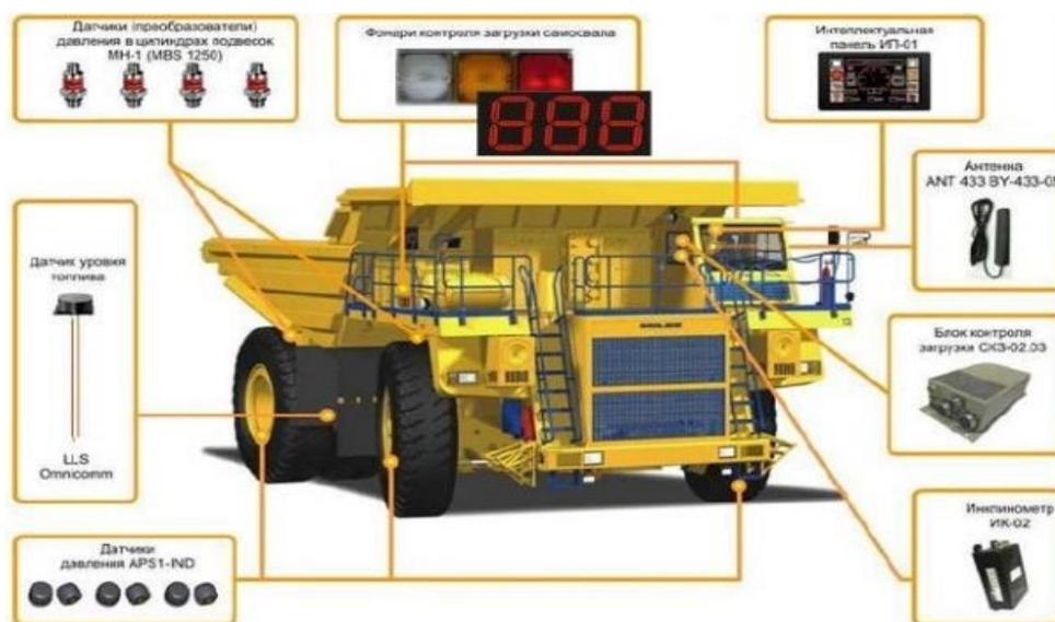
Рисунок 11 – Потребность в датчиках и оборудовании для контроля работы автосамосвала
