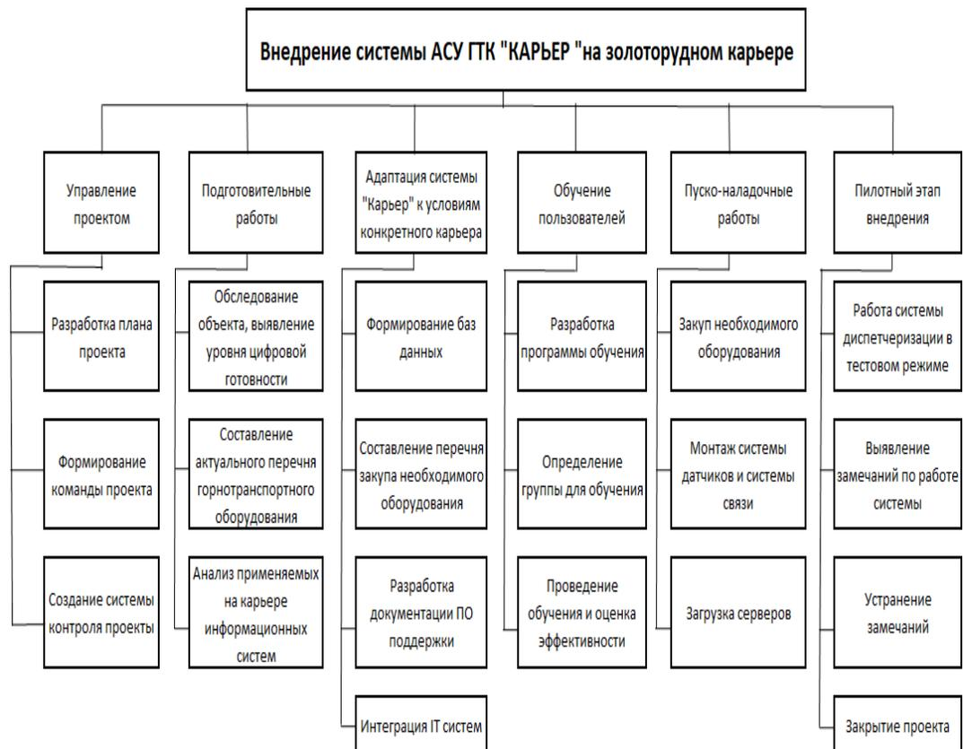
**Рисунок 9 – Иерархическая структура работ по проекту**
